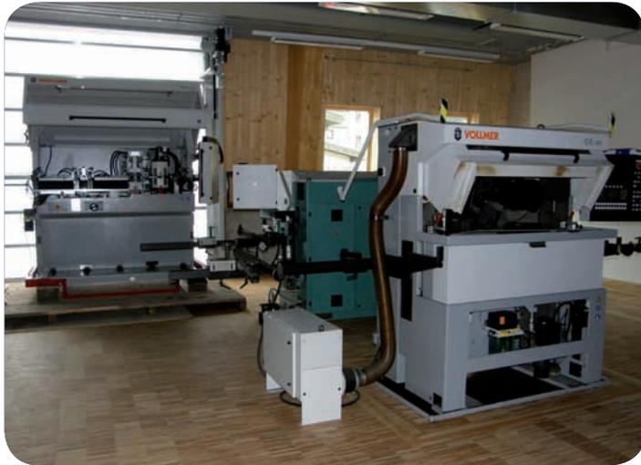
*Ein Vollmer-Richtzentrum sowie eine Schärfanlage für Bandsägen stehen zur Verfügung*
