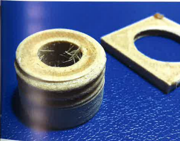
Erste, mit Holz gedruckte Teile weisen gebrauchsfähige Festigkeiten auf. In weiterer Folge gilt es, Einsatzzwecke für das neue Material zu finden.
