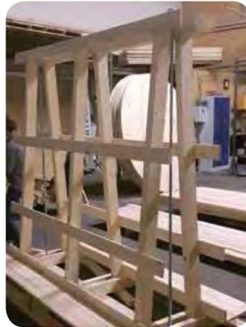
Im Verlauf der Diplomarbeit wurden die beiden Konzepte erstellt, statisch berechnet, CAD-Zeichnungen angefertigt und eine Wirtschaftlichkeitsberechnung durchgeführt. Nachdem man mit den errechneten Werten, die mit den Werten der zuvor durchgeführten Marktanalyse verglichen wurden, zufrieden war, machte man sich daran, von jedem Konzept einen Prototyp zu bauen.
