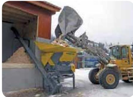
Referenzanlage der Firma UNTHA für die Zerkleinerung von Sägewerkabfällen.
