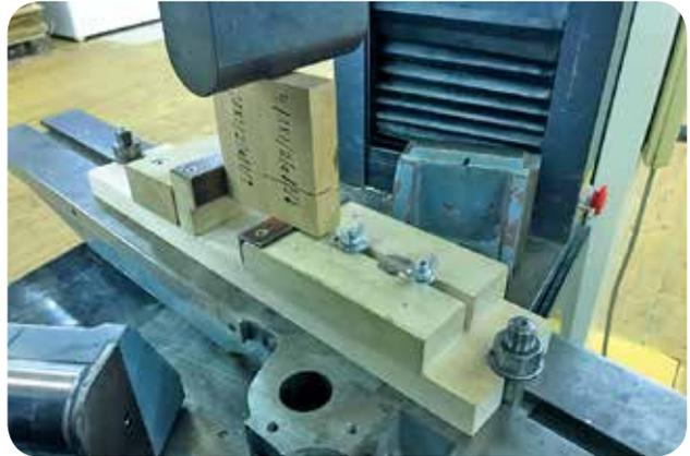
Anschließend wurden alle Proben einer Scherprüfung unterzogen. Das Bruchbild wurde visuell analysiert und in einen Klebstoffbruchanteil und einen Holzbruchanteil aufgeteilt. Die gemessenen Werte wurden ausgewertet. Aufgrund der Proben, bei denen die größte Scherfestigkeit aufgetreten war, konnte die Ursache gefunden werden.
