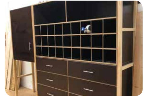
Die Freiwillige Feuerwehr wollte außerdem einen Funktionskasten zur Aufbewahrung der Atemschutzflaschen und der Atemschutzmasken. Der Hängekasten, der gebaut werden sollte, hatte Platz für Dokumente. Die vielen unterschiedlichen Winkel im Raum der Freiwilligen Feuerwehr wurden ein bisschen zum Problem beim Ausmessen des Raumes. Wir ermittelten die Raummaße mittels eines Lasers. Danach wurde der Grundriss auf Auto CAD angefertigt.
