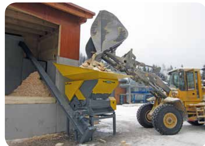
Referenzanlage der Firma UNTHA für die Zerkleinerung von Sägewerksabfällen.
