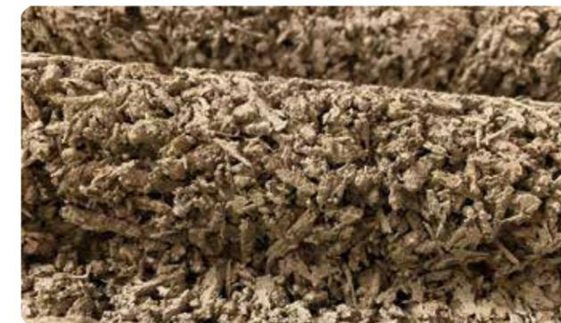
Das Produkt Holzspanbeton setzt sich aus Zement, Wasser und Holzspänen zusammen. Dieses Gemisch wird für die Produktion von Lärmabsorbieren der Firma DELTA BLOC International GmbH verwendet. Das Ziel dieser Diplomarbeit ist die Untersuchung des Hydratationstemperaturverlaufs diverser Holzarten als Mittel zur Bestimmung der Holzarten-Eignung in Holzspanbeton. Zudem wurde eine Recherche zu Bindemitteln, Additiven und Holzinhaltstoffen, sowie Holzeigenschaften
