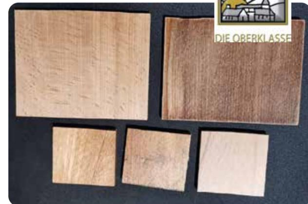
herausgestellte, sind alle vier Behandlungen gute Möglichkeiten Buchenholz zu färben. Die besten Möglichkeiten sind die thermische Behandlung und die Imprägnierung mit Tannin. Die Behandlung mit NATwood und die Imprägnierung mit Dämpfkondensat sind für diese Anwendung noch nicht vollständig ausgereift, jedoch sehr vielversprechende Optionen.
