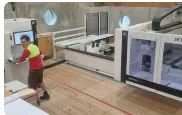
Achs CNC BMG310 mit Kantenanleimaggregat von Homag wurde in der ersten Schulwoche in Betrieb genommen. Kurze Zeit später die Maschine mit einer neuen WoodWop CAM Plugin+ Software nachgerüstet, um der industriellen Einzelfertigung nachzukommen. Mit dieser Software können speziell 3-dimensionale Objekte konstruiert oder übernommen werden.
