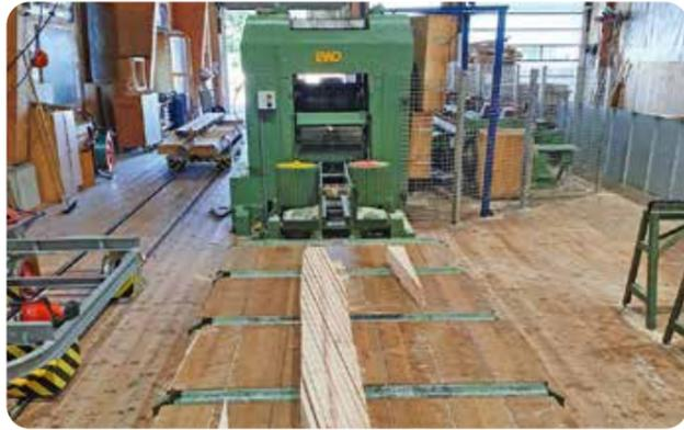
Es wurde ein Vergleich vom Einschnitt mit der Blockbandsäge und dem Einschnitt mit der Gattersäge im Hinblick auf den Schrägschnitt erstellt. Weiters wurde ein Programm mit MS-Excel geschrieben, um die Ausbeute vom Schrägschnittholz auf der Gattersäge zu erhalten. Ein weiteres Ziel war es, erstmals den Einschnitt mit dem Gatter durchzuführen und den Ablauf zu analysieren, um
