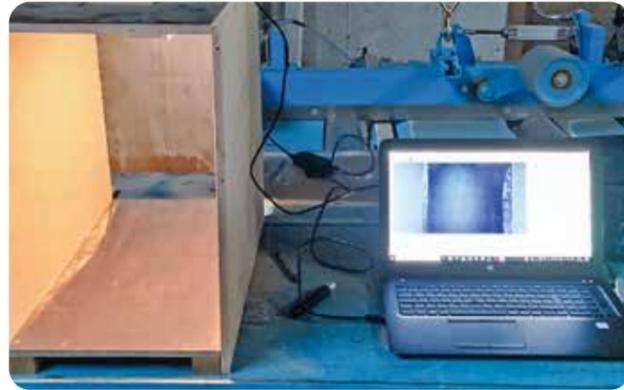
gescannt und durch einen Strichcode gekennzeichnet. Die Qualitätseinteilung übernimmt eine Künstliche Intelligenz, welche Holzmerkmale wie Äste, Risse, Splint oder Verfärbungen erkennt und somit die Deckschichten in fünf Qualitäten sortiert.
