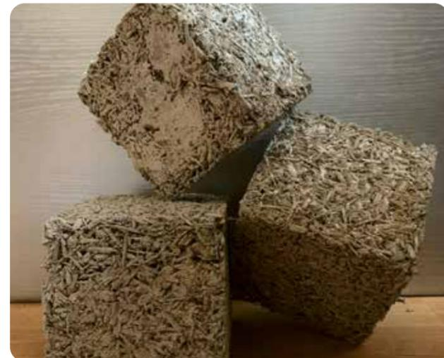
Nagel Auszieh Widerstand, die Druckfestigkeit, sowie auf die Dickenquellung geprüft. Anschließend wurden die Ergebnisse ausgewertet und überprüft, ob die von EPAL gestellten Anforderungen erfüllt werden konnten.
