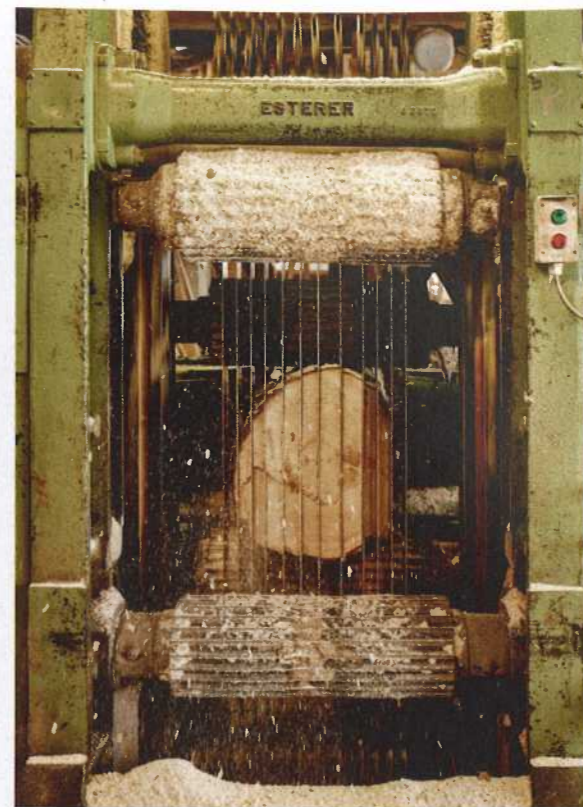
Schnittig. Mit dem Vollgatter aus den 1960er-Jahren geht es der Fichte ans Holz.
